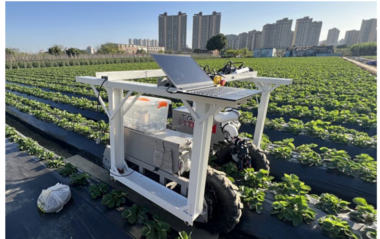
Robotizovana mašina za berbu jagode kombinovana sa sistemom kompjuterskog vida
